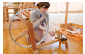
糸を巻き取る管(くだ)巻き。作品の完成度を左右する肝心な作業。
