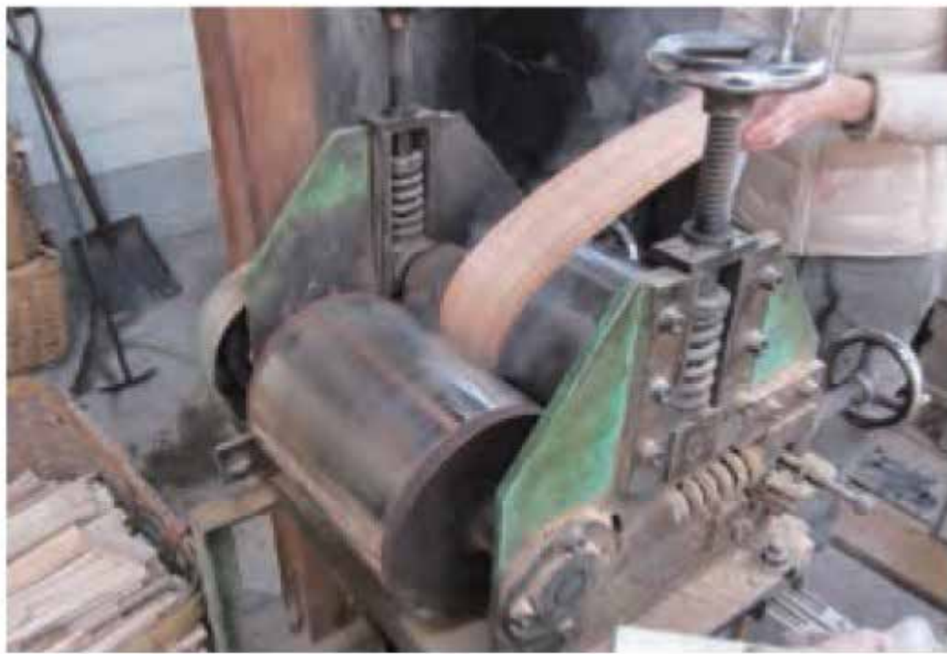
ローラーをガスで温める仕組み。より厚い板を曲げる事ができる
